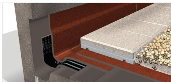
Protección pesada. No transitable. Grava con INVERLOSA
