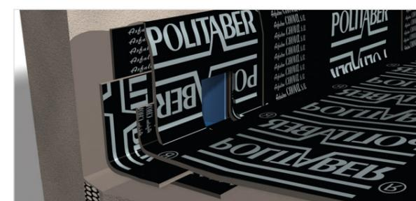
Membrana con protección pesada (membrana adherida)
