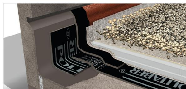
Cubierta invertida. No transitable, acabada con grava.
