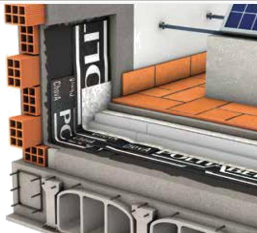
Nota.- Se deberá tener especial cuidado en el tratamiento de los detalles de la instalación de los equipos, tuberías, etc. Respetando siempre membrana impermeabilizante para evitar filtraciones posteriores. Los elementos pasantes, de haberlos, deberán preverse con anterioridad y tratarlos adecuadamente. Lo mismo, si se deben realizar fijaciones u otras actuaciones que puedan afectar a la impermeabilización.
