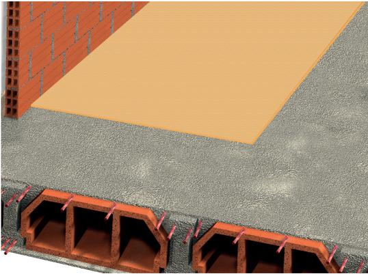
1- Previamente a la instalación de la lámina se habrá comprobado que la superficie esté limpia, seca y libre de irregularidades. A continuación, comenzar a extender la lámina de polietileno.
