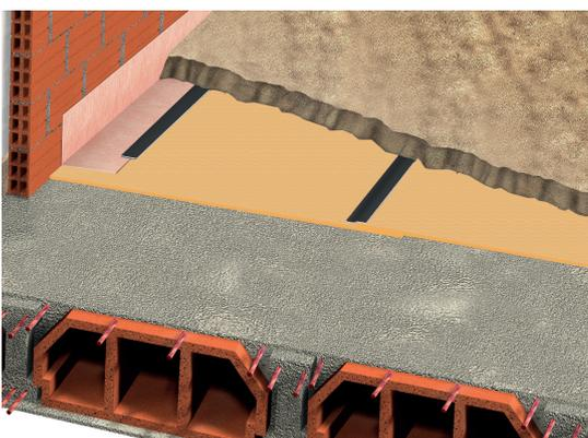
4- Por último, realizar la solera de motero armada de al menos 50 mm de espesor. En cuanto a las dosificaciones y armado de la solera se seguirán las recomendaciones de la dirección facultativa.
