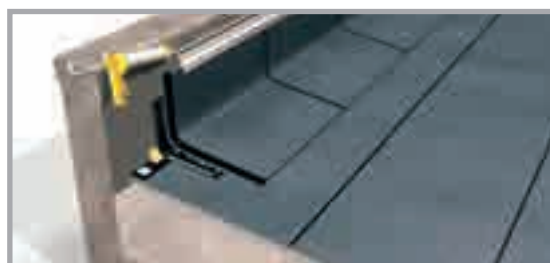
Remate realizado con perfil metálico y chapa de acabado.
