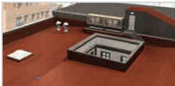
En cubierta ADHERIDA, con Protección Ligera, se hubiera IMPRIMADO TODA la superficie.
