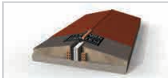
APLICACIÓN DE LA BANDA DE ACABADO. (Superior).
