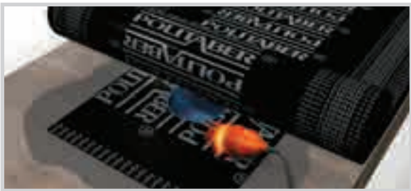
APLICAR LA MEMBRANA IMPERMEABILIZANTE.
