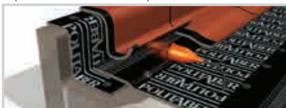
REMATAR CON LÁMINA AUTOPROTEGIDA. (Ejemplo: "MONOCAPA").
