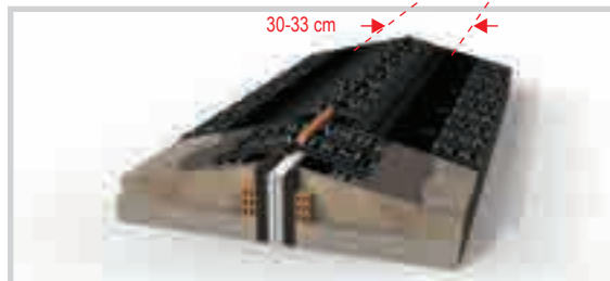
APLICACIÓN DE LA BANDA DE ACABADO. (Superior).
