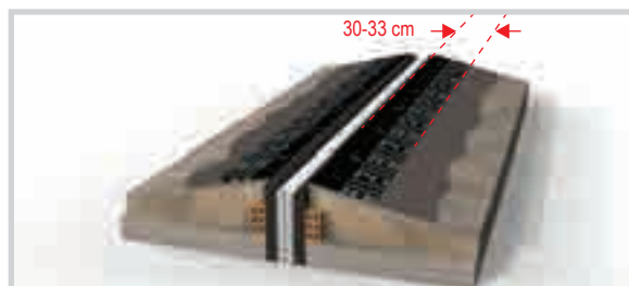
APLICACIÓN DE LAS BANDAS DE ADHERENCIA.
