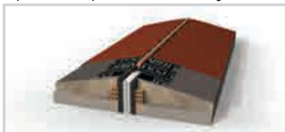
APLICACIÓN DE LA MEMBRANA IMPERMEABILIZANTE.
