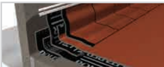
DETALLE DE MEMBRANA BICAPA.
