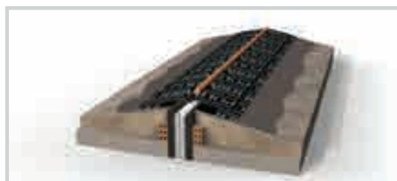
APLICACIÓN DEL MATERIAL DE RELLENO DE JUNTAS.
