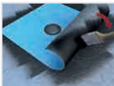
IMPRIMAR cara del geotextil del SANIBRIC. Y se adherirá al soporte.
