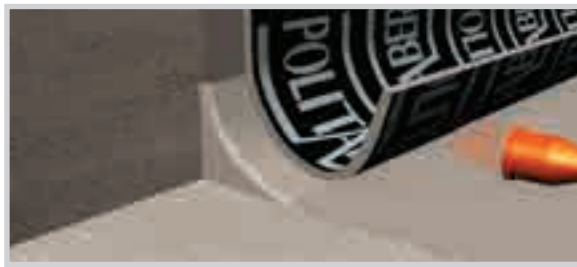
APLICACIÓN DE LABANDA DE REFUERZO.
