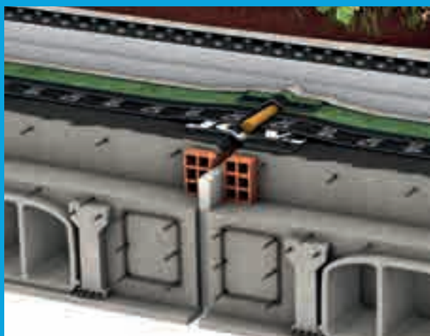
DETALLE JUNTA ESTRUCTURAL
