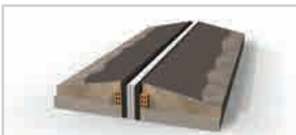
PREPARACIÓN DE LA JUNTA ESTRUCTURAL Y RELLENO DE LA MISMA. IMPRIMADA.
