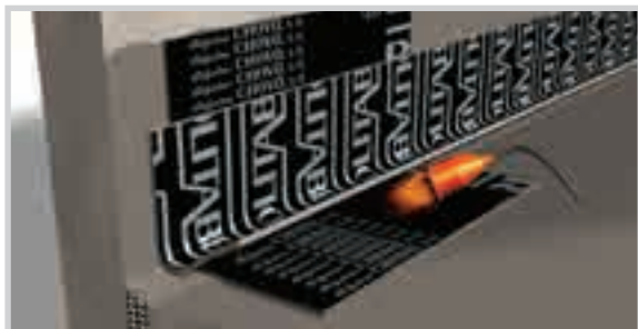
APLICAR BANDA DE REFUERZO
