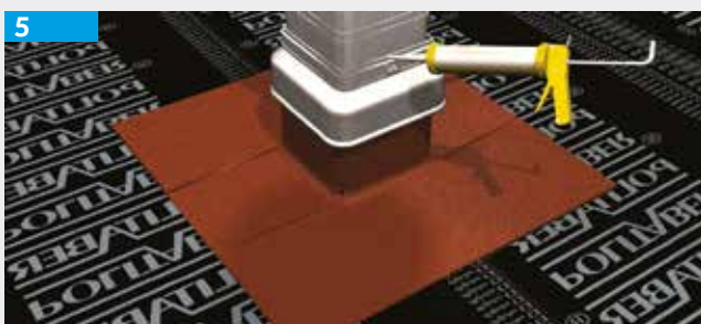
5 Aplicación de un sombrerete. Sellado del mismo con masilla.
