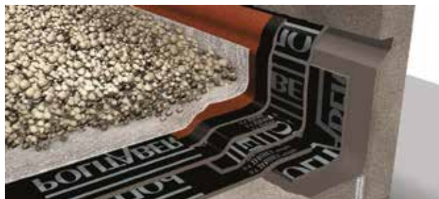
Cubierta convencional. No transitable, acabada con grava. Bicapa
