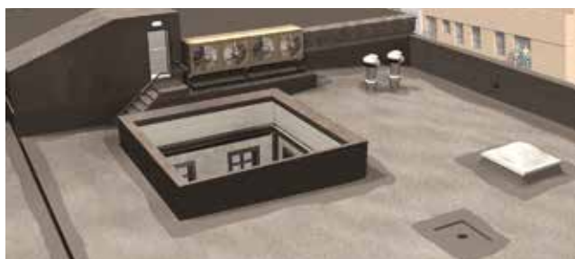
Ejemplo de imprimación en cubierta no adherida, con protección pesada.
