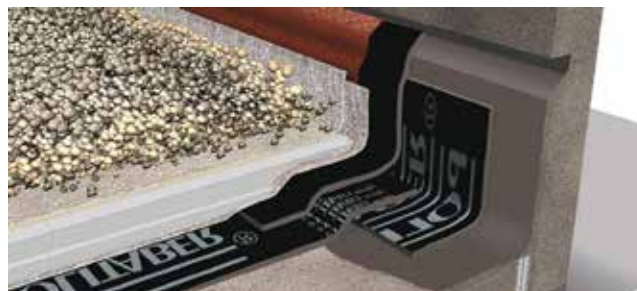
Cubierta invertida. No transitable, acabada con grava.
